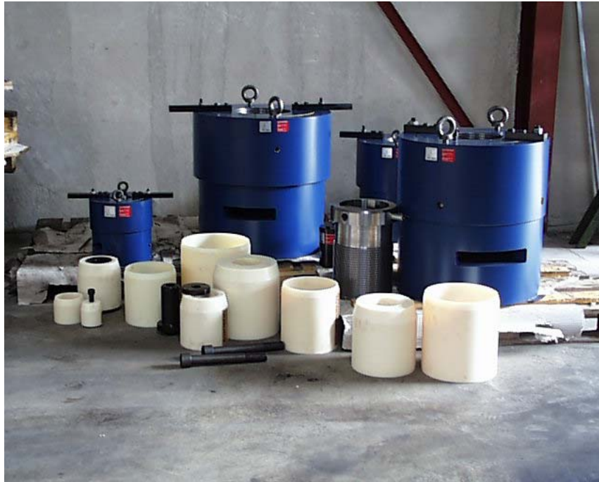
Schraubenspannvorrichtung zur Zugankerverspannung an Schmiedepressen
