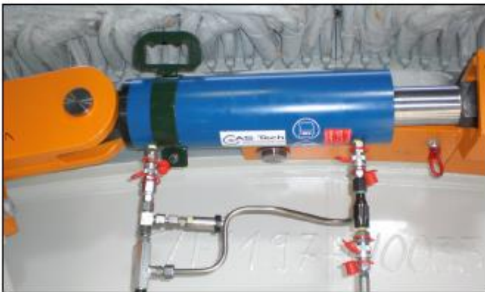
Ausführung mit Hydraulikzylinder Assembly with Hydraulic Cylinder
